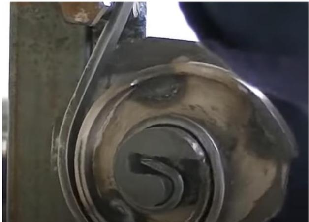
Figura 5. Máquina rizadora en funcionamiento
